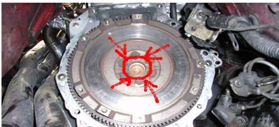
Selon l'envie et le budget de chacun, c'est là aussi le moment opportun pour monter un volant moteur allégé, un disque et un mécanisme renforcé :-)
