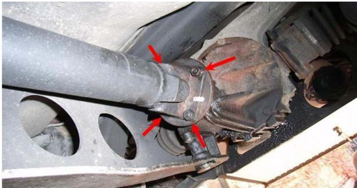
Vous pouvez maintenant enlever l'arbre de transmission en l'inclinant l'arrière vers le bas et en le faisant coulisser vers l'arrière de la voiture. Il glissera hors de la boîte. Il se peut qu'un peu d'huile coule par l'arrière de la boîte, prévoyez au minimum un carton sous la voiture.
